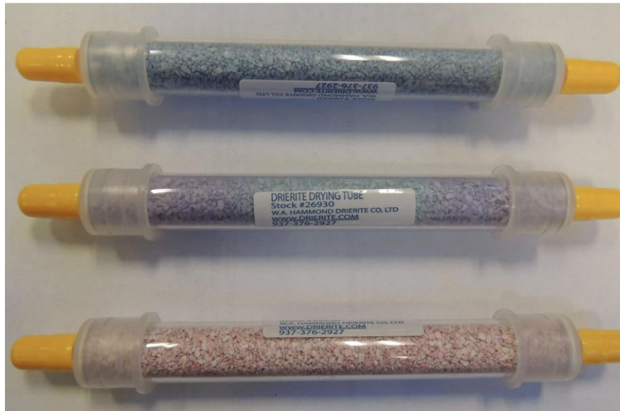
Figura 22. Tubos antihumedad (Google Special Collect, 2016).
