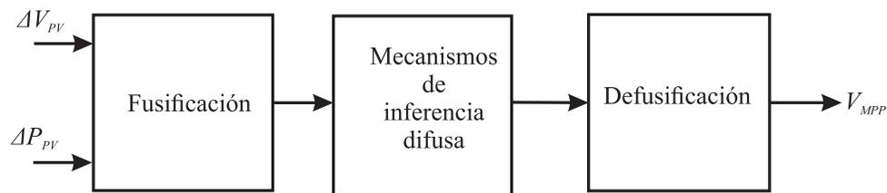
Figura 2.15: Diagrama de flujo del control de lógica difusa (modificado de [27]).
