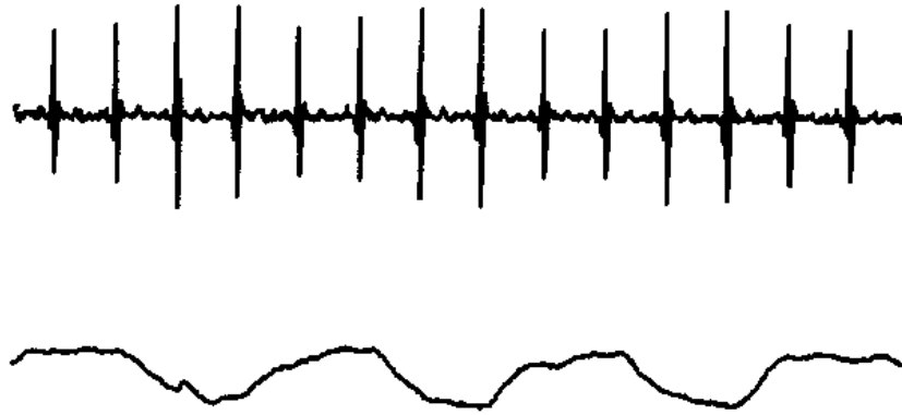
Figura 7. Modulación inducida por la respiración en la amplitud del QRS. Trazo superior: ECG; Trazo inferior: respiración medida por un transductor de respiración colocado alrededor del tórax. Duración: 10 segundos (49).
