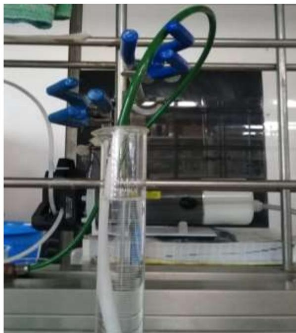
Figura 2.3. Sistema de absorción de  $\text{CO}_2$
