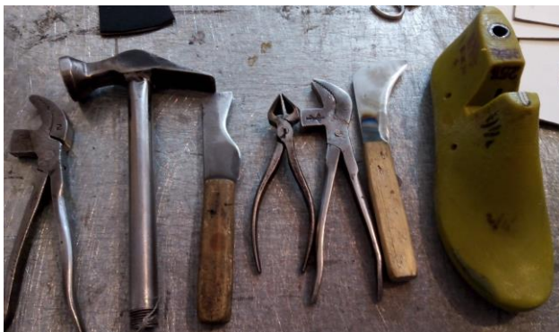
Figura: 14 Herramientas que utilizan para el proceso de montado pinzas de montado, martillo, cuchillo de montado, alicatas, pinzas de montado y hormas(fotografía propia)
