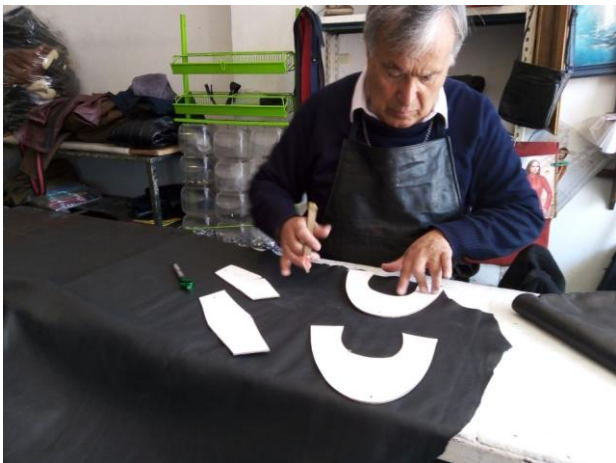
Figura: 17 Se muestra en la imagen al señor Agapito cortando sobre una hoja de piel con ayuda de molde, para una mayor precisión (fotografía propia)
