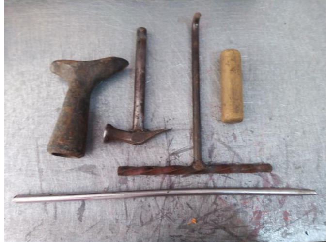
Figura: 16 Herramientas que utilizan para el proceso de montado pie, martillo ancla de sacar horma, madera para dobladillar, varilla de sacar hormas ( fotografía propia)
