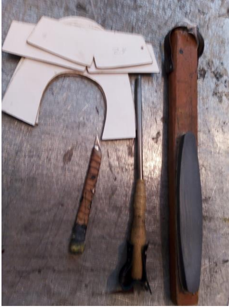
Figura: 15 Herramientas que utilizan para el proceso de cortado son los moldes, navaja de cortado, chaira y piedra de afilado (fotografía propia)
