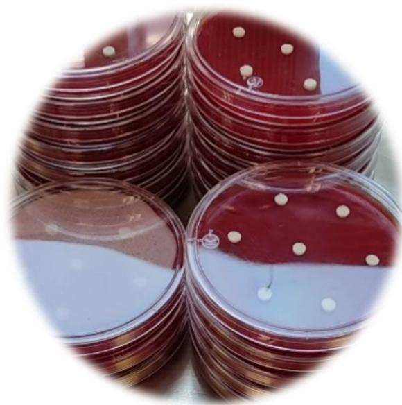
**Figura 12.** Disposición de los ionómeros de vidrio con y sin carga de nanotubos en las placas Mueller-Hinton.
