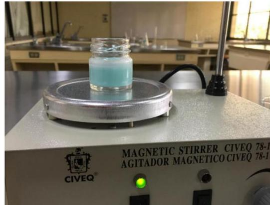
**Figura 6.** Mezcla de nanotubos de haloisita con clorhexidina.
