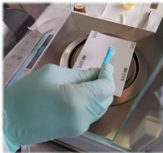
**Figura 8.** Determinación de la cantidad de nanotubos a incorporar a los ionómeros de vidrio.
