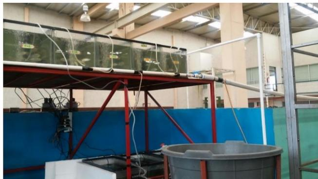
Figura 2. Peceras montadas y su sistema de recirculación.
