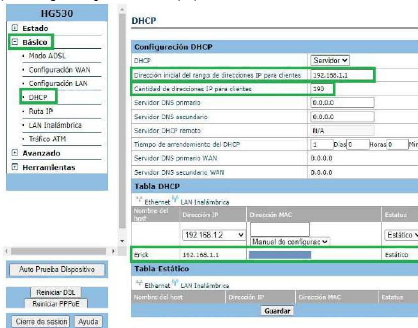
Figura 76. Ejemplo de asignación de una dirección IP estática a un equipo llamado Erick (Fuente Propia).
