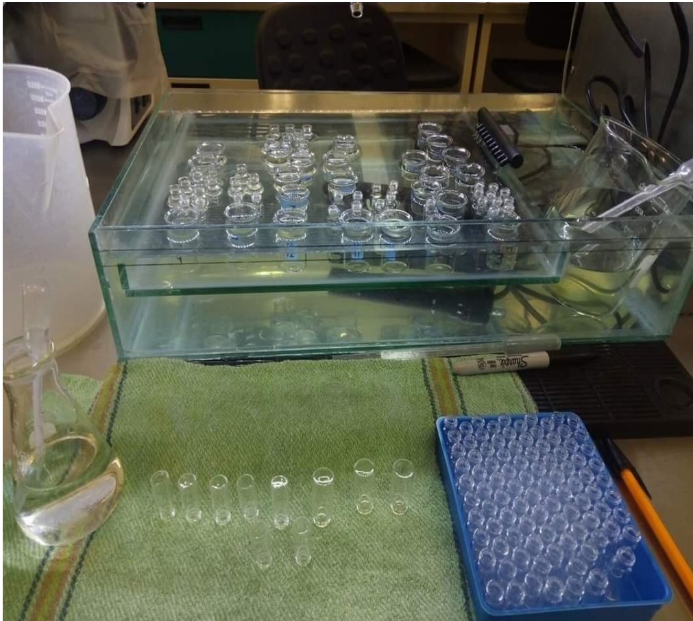
Figura 5. Baño de agua para controlar las condiciones ambientales para el cultivo de Daphnia pulicaria obtenido de la NMX-AA-087-SCFI-2010.
