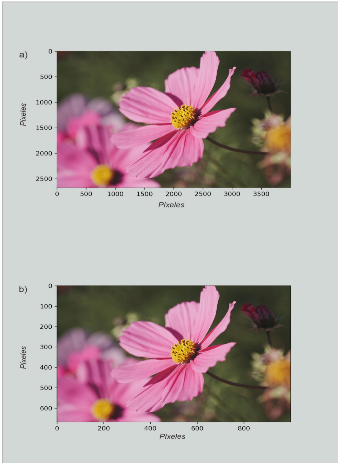
Figura. 8: Escalación de la imagen dentro de la función takePhoto . a) posee una resolución de 10.6 megapíxeles, su tamaño es de 4000x2672 píxeles. Por otro lado, b) muestra la misma imagen, pero en resolución de 2.6 megapíxeles con tamaño de 1000x668 píxeles. Fue reducida en un 75% con respecto a la original (elaboración propia).
