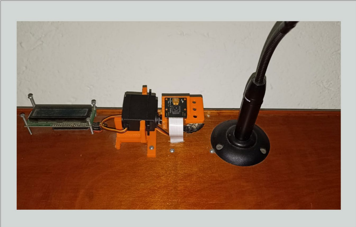
Figura 16: Fotografía de la base de sujeción del servomotor y soporte de la cámara con cavidades para semáforo una vez colocado en la paleta del atril automatizado (elaboración propia).
