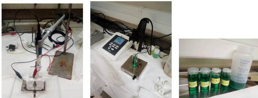
Figura 4.1: Síntesis por electrodeposición variando el pH del electrolito.
