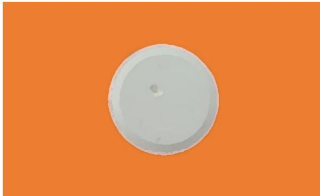
Figura 8.2: *Extracción inducida por termoablación láser en el comprimido circular de  $\text{Sm}_2\text{O}_3$  a una energía de 47.194 mJ/pulso, frecuencia de 10 Hz y tiempo de 10 min.*
