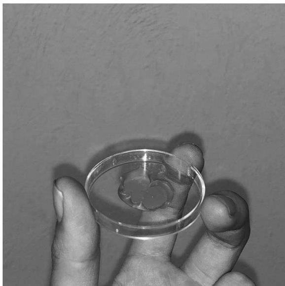
Fig 3.5. Películas después del baño de cloruro de calcio
