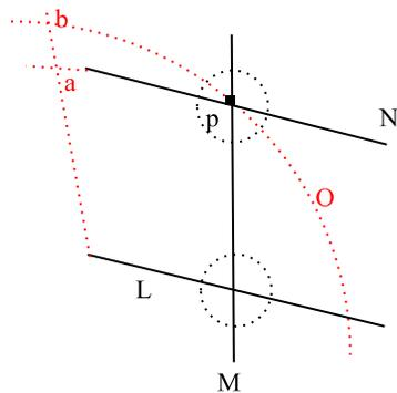
Construcción. Dada una recta L y un punto p, trazar una recta M que pase por p y cruce a L. Trazar por P una recta N que cruce a M formando un ángulo igual al que L forma con M.
