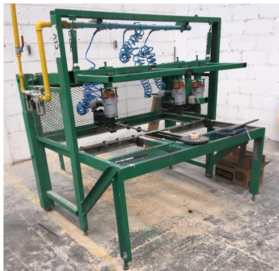
Figura 6.- Clavadora neumática para balonas pequeñas (elaboración propia, 2022)
