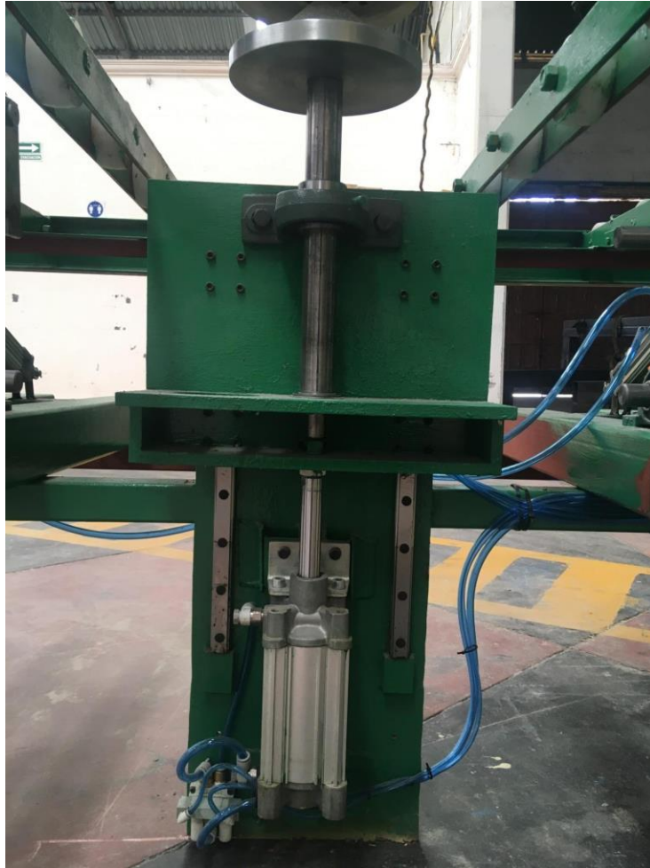
Figura 40.- Centro elevador (elaboración propia, 2022)
