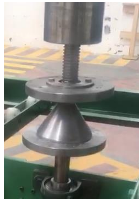
Figura 42.- Alineación del tope mecánico (elaboración propia, 2022).
