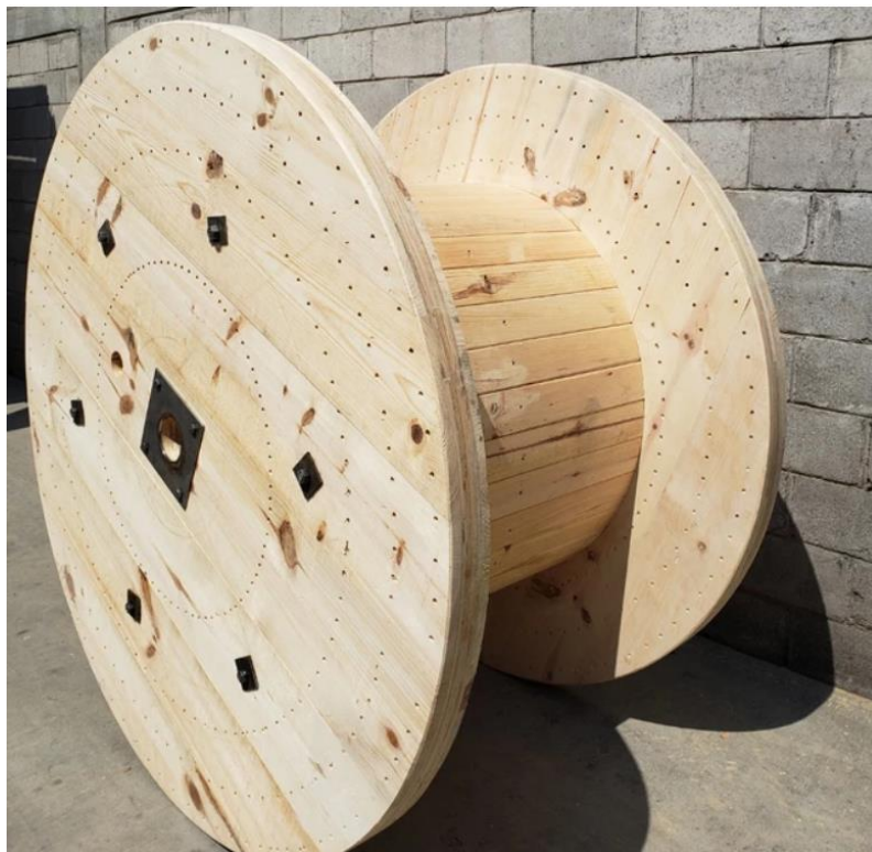
Figura 54.- Carrete ensamblado con balonas clavadas con la máquina clavadora neumática (elaboración propia, 2022).
