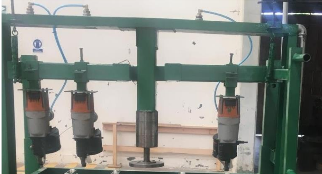
Figura 44.- Soportes de pistola montados con pistolas conectadas a la alimentación (elaboración propia, 2022).
