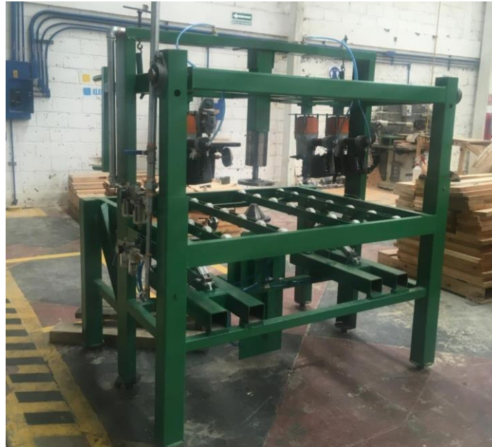
Figura 48.- Vista trasera de la máquina clavadora neumática (elaboración propia, 2022).
