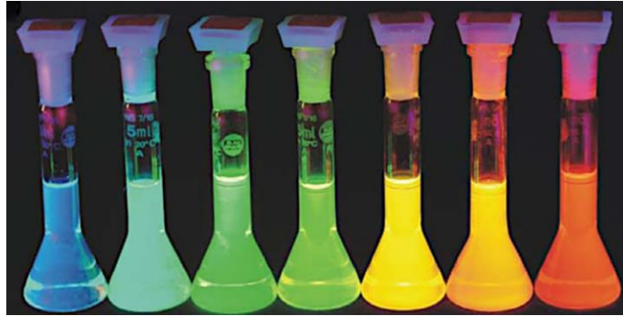
Figura 8. Fluorescencia de Nanopartículas core-shell de CdSe-CdS con diámetros de 1.7nm (azul), a 6 nm (rojo).
