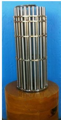
Figura 2. 5. Lápices de acero inoxidable utilizados para el almacenamiento de  $^{60}\text{Co}$ .
