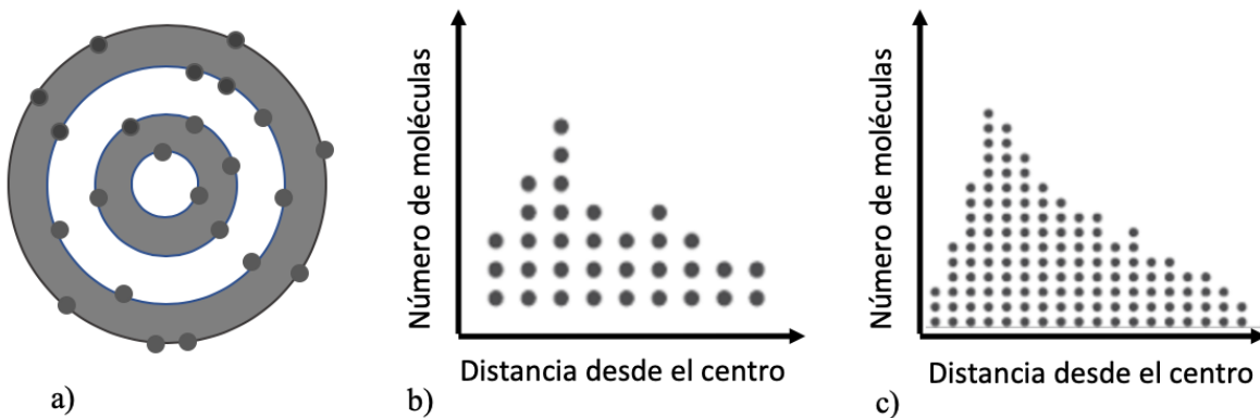
Figura 2: Esquema de distribución de partículas. a) Vista radial desde un átomo, b) gráfica del número de moléculas para un átomo, c) incremento en el número de átomos.
