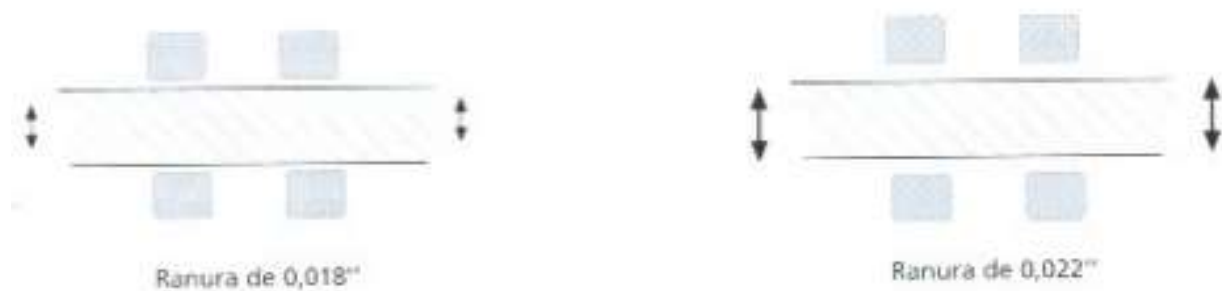
Figura 7. Diferencia entre ranura 0.018" y 0.022". 23
