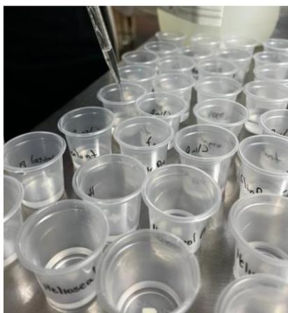
**Fotografía 7:** Los selladores se almacenan en 3 ml. de agua desionizada, se mezclan con parrilla magnética y se dejan reposar por 5 minutos. Fuente propia
