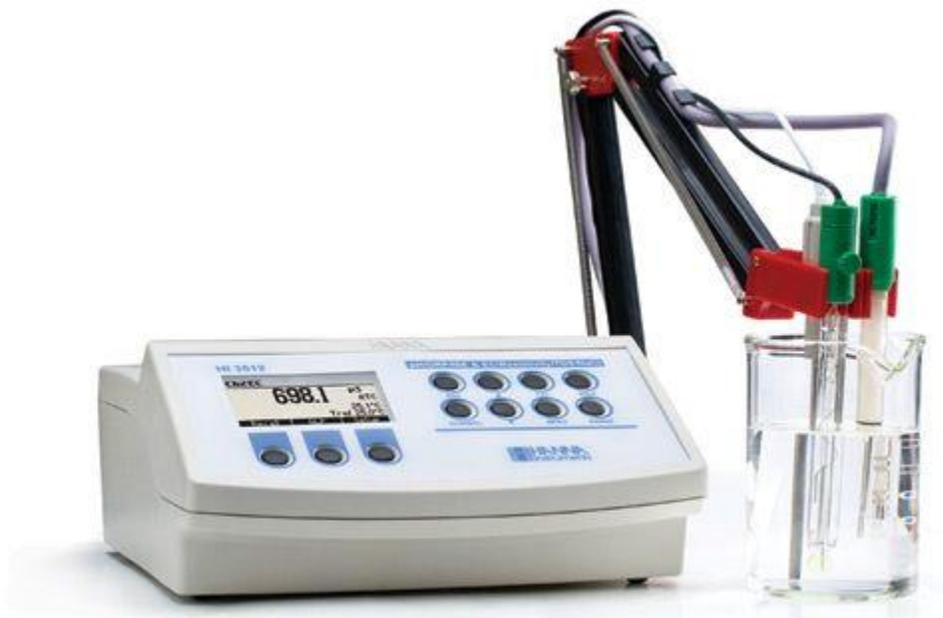
**Ilustración 1:** modelo 1011 Hanna Instruments, Fuente: Hanna - Instrumentos para la medición de la calidad del agua y de alimentos (hannaarg.com).
