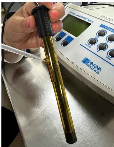
**Fotografía 2:** calibración de potenciómetro con el TISAB II y las diferentes muestras de fluoruro en sus distintas concentraciones. Fuente propia
