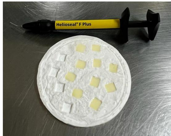
**Fotografía 4:** De cada marca comercial se necesitaron obtener 10 muestras para realizar las pruebas y estas se obtuvieron con ayuda de una plantilla de teflón. Fuente propia
