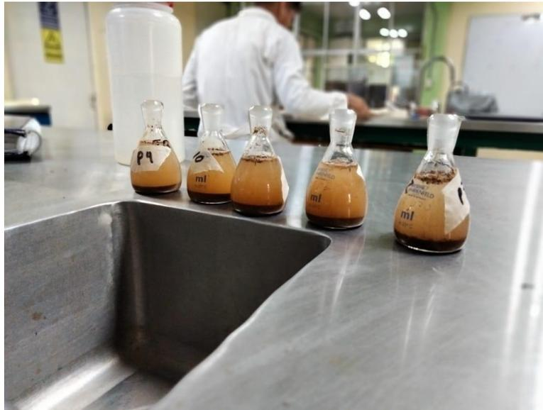
Ilustración 15 Determinación de densidad real del suelo.
