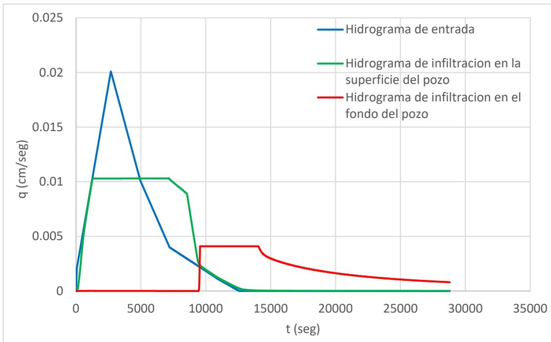
Figura 4.21: Hidrogramas de entrada y salida
