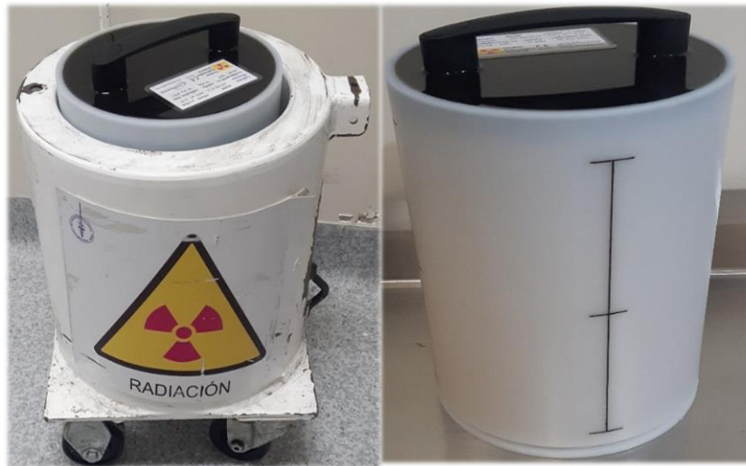
Figura 13. Fuente sellada de Germanio – 68 con su respectivo contenedor blindado para transporte.
