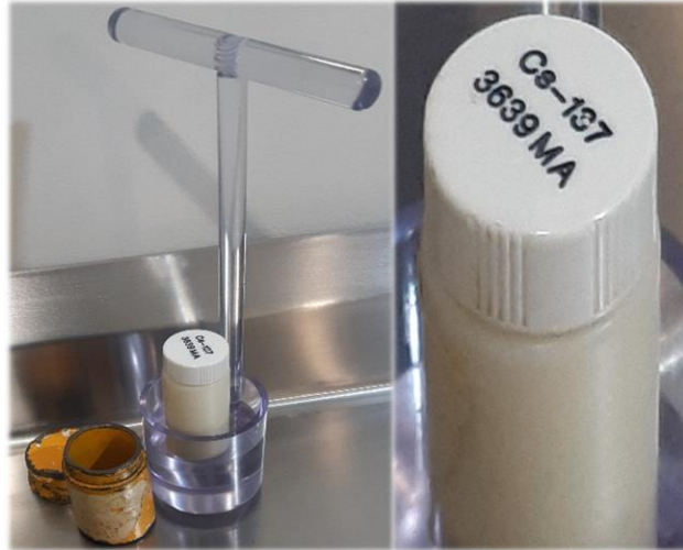
Figura 6. Fuente sellada de Cesio-137, con su respectiva canastilla para transporte y su blindaje.
