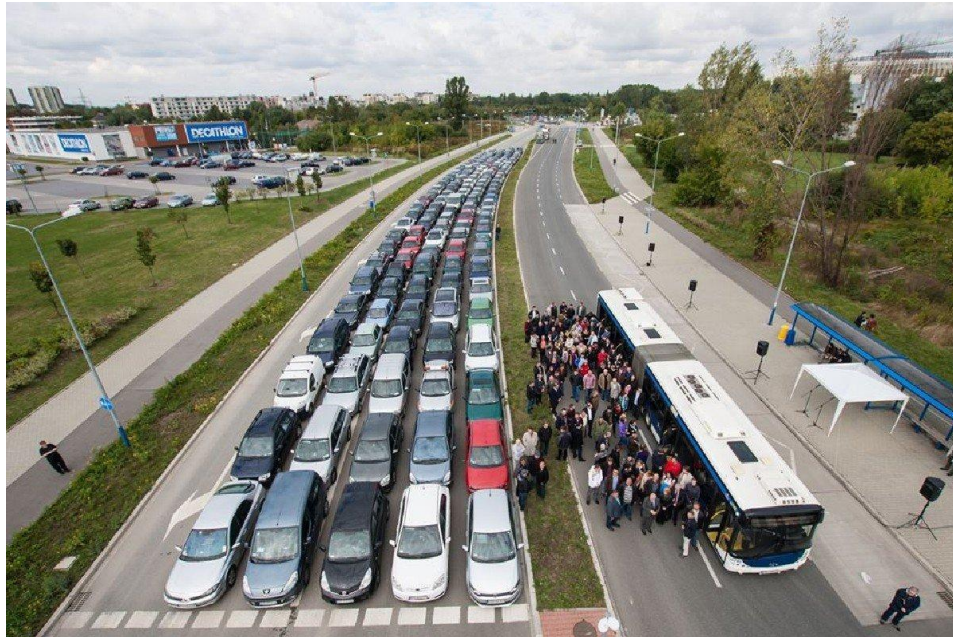
Ilustración 54 - Un autobús tipo BRT tiene capacidad de transportar 70 personas, el equivalente a 70 automóviles. Fuente: Imagen cortesía de Auto10.com
