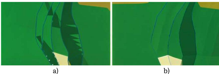
Las superficies TIN son una forma de datos geográficos digitales basadas en vectores y se construyen mediante la triangulación de un conjunto de puntos [11], en este caso, el proceso termina realizando una conversión a formato ráster tipo ASCII para su posterior incorporación al modelo IBER.
