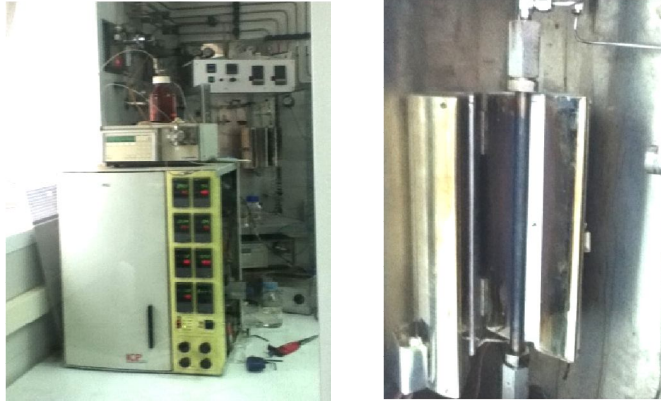
Figura 3.10. Reactor de lecho empacado.
