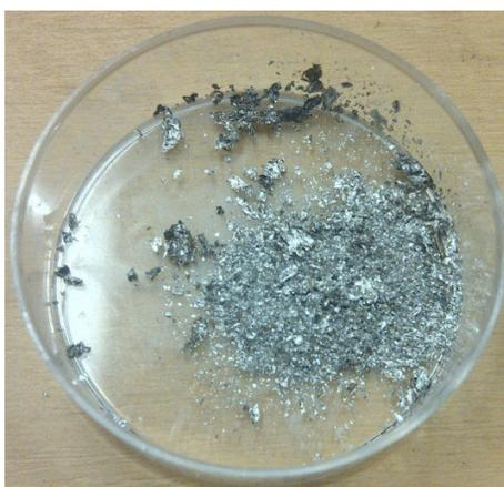
Figura 2.3 Restos de aluminio después de la pirólisis.
