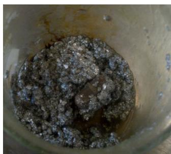
Figura 2.8 Muestra de aluminio, aceite y polietileno remanente después de una hora de calentamiento.
