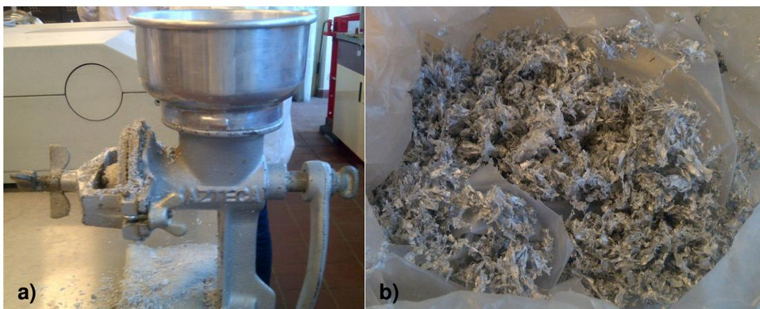
Figura 2.5 a) Molino usado para triturar la muestra, b) Muestra con un tamaño de partícula pequeño.
