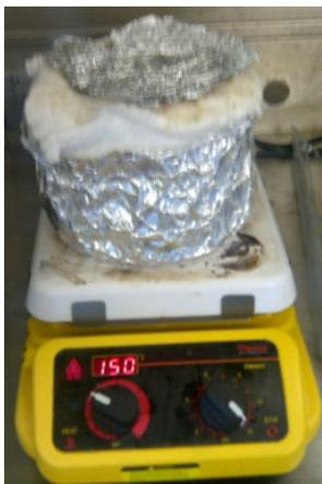
Figura 2.6 Parrilla de calentamiento con el equipo de aislamiento alrededor del vaso de precipitado.
