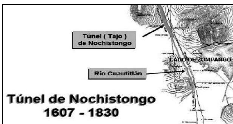
Figura 10. Ubicación del túnel o tajo de Nochistongo con lo que se desvían las aguas del río Cuautitlán, evitando que lleguen a Zumpango.
