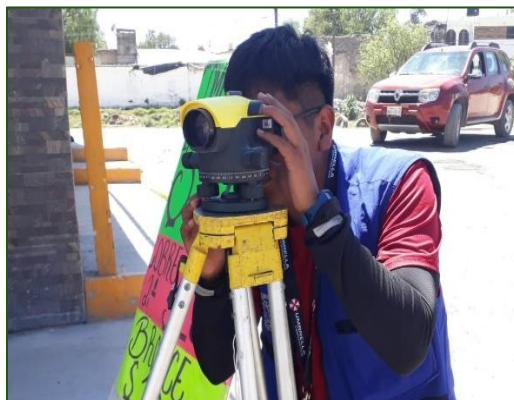
Figura 19. Uso del nivel óptico topográfico
