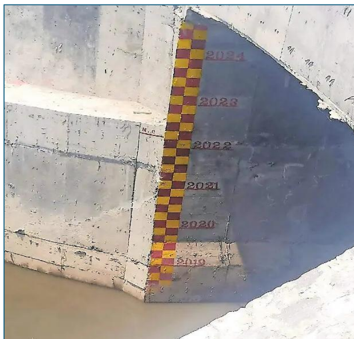
Figura 44. Regleta de medición establecida por la CONAGUA
