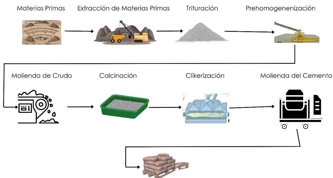
Figura 2. Procesos de fabricación del cemento. elaboración propia con base en la información de (Cemex, 2023).
