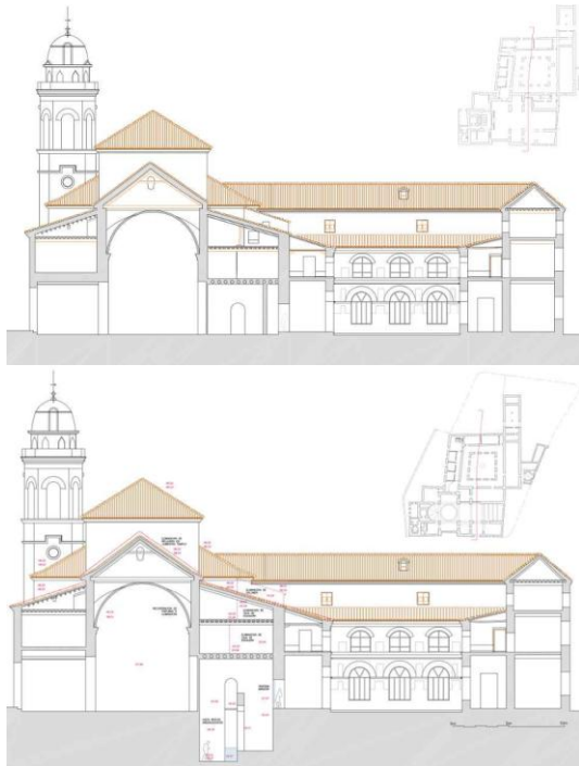
Imagen 74: Cortes del templo antes en la parte superior y después en la parte inferior
