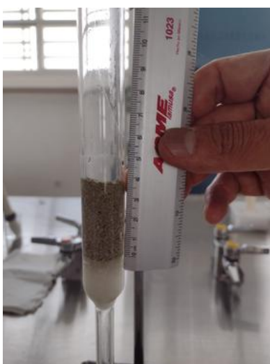
Figura 25 Medición de la altura de lecho (3.5 cm)
