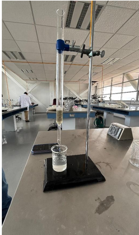
Figura 27 Remoción de gasolina emulsionada en flujo continuo, en lecho fijo (3.5 cm)
