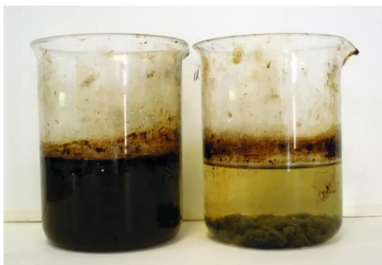
Figura 7 Coagulación y floculación de hidrocarburos en agua
