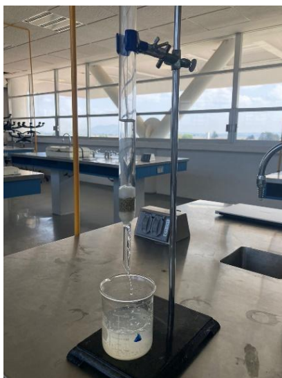
Figura 26 Proceso de remoción de gasolina emulsionada en agua en flujo continuo y lecho fijo (1.8 cm)
