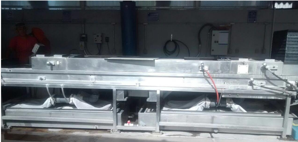
Figura 1. Máquina lavadora de charolas para invernaderos de AgroGuanajuato S.A de C.V.
