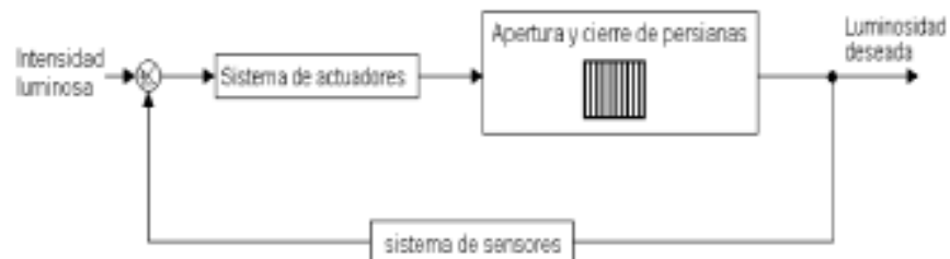
Figura 4. Sistema autónomo de apertura y cierre de persianas
