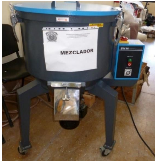
Imagen 2.1 Mezclador Vertical SVM-50 de Shini Plastics
