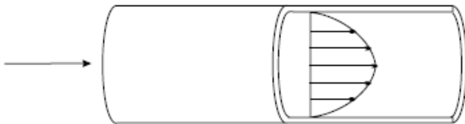
Imagen 3.1 Flujo de Poiseuille en el interior de un tubo [26]
