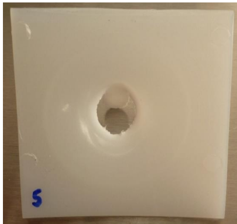
Imagen 3.4 Tipo de rotura frágil de las muestras sometidas a impacto de dardo
