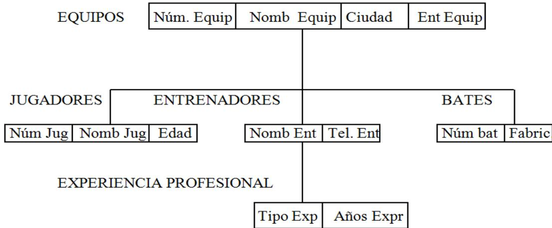
Fig. 4.11 Jerarquía de los equipos en la que se muestran los nombres de segmento y de campo.
