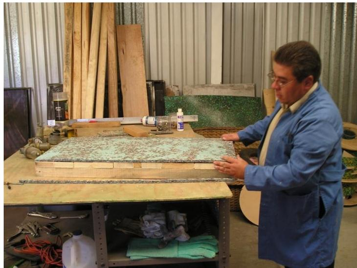
Figura V.4: El Ing. Tonatiuh Vázquez en su planta, posicionando la placa de polietileno sobre la tarima.
