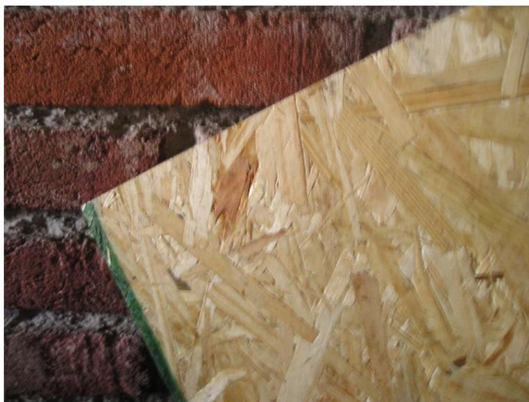
Figura V.8: Vista cercana del panel de astillas de madera comercializado como OSB (Oriented Strand Board)
