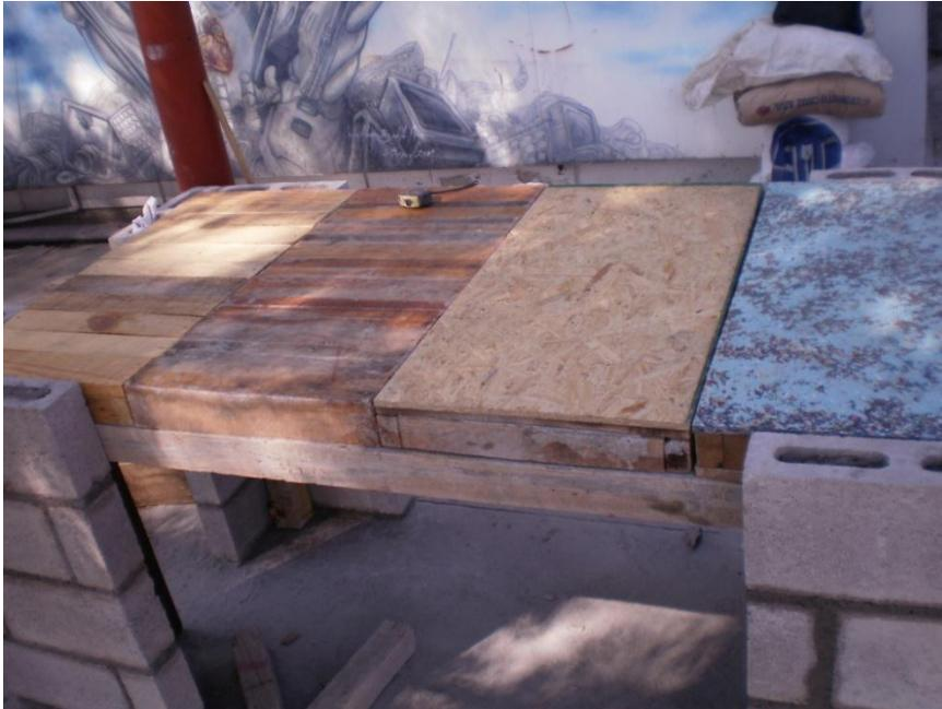
Figura V.5: El 18 de noviembre 2010 se cimbra una superficie de 2 m<sup>2</sup> con cuatro tarimas, cada una de las cuales presenta una superficie de contacto diferente
