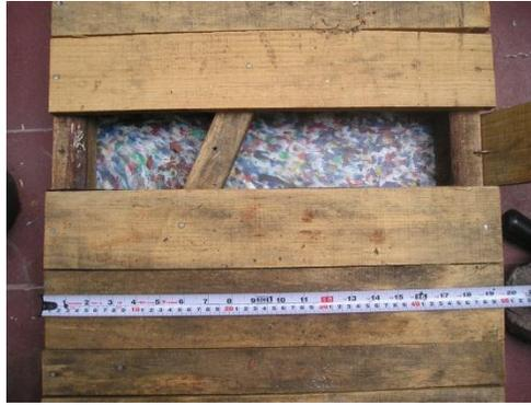
Figura V.1: Proceso de sustitución de la madera por la placa de polietileno reciclado
