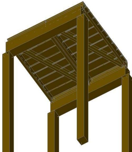
Figura IV.3: Vista inferior de  $1\text{m}^2$  de cimbra convencional de madera, formado por dos tarimas. Se observan las vigas y los puntales.
