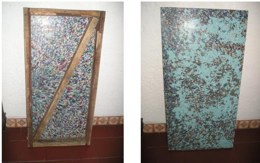
Figura 8: Superficie de contacto polietileno reciclado montado en la estructura convencional de una “tarima” de madera.
