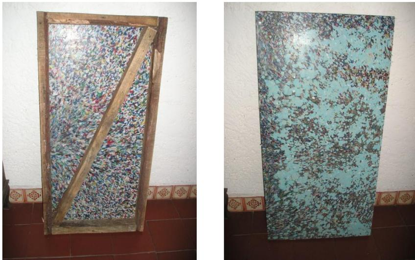
Figura V.2: Superficie de contacto polietileno reciclado montado en la estructura convencional de una tarima de madera (Fuente: datos del autor generados en la presente investigación)
