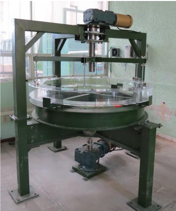
Figura 13. Canal rotatorio instalado en el CIRA.
