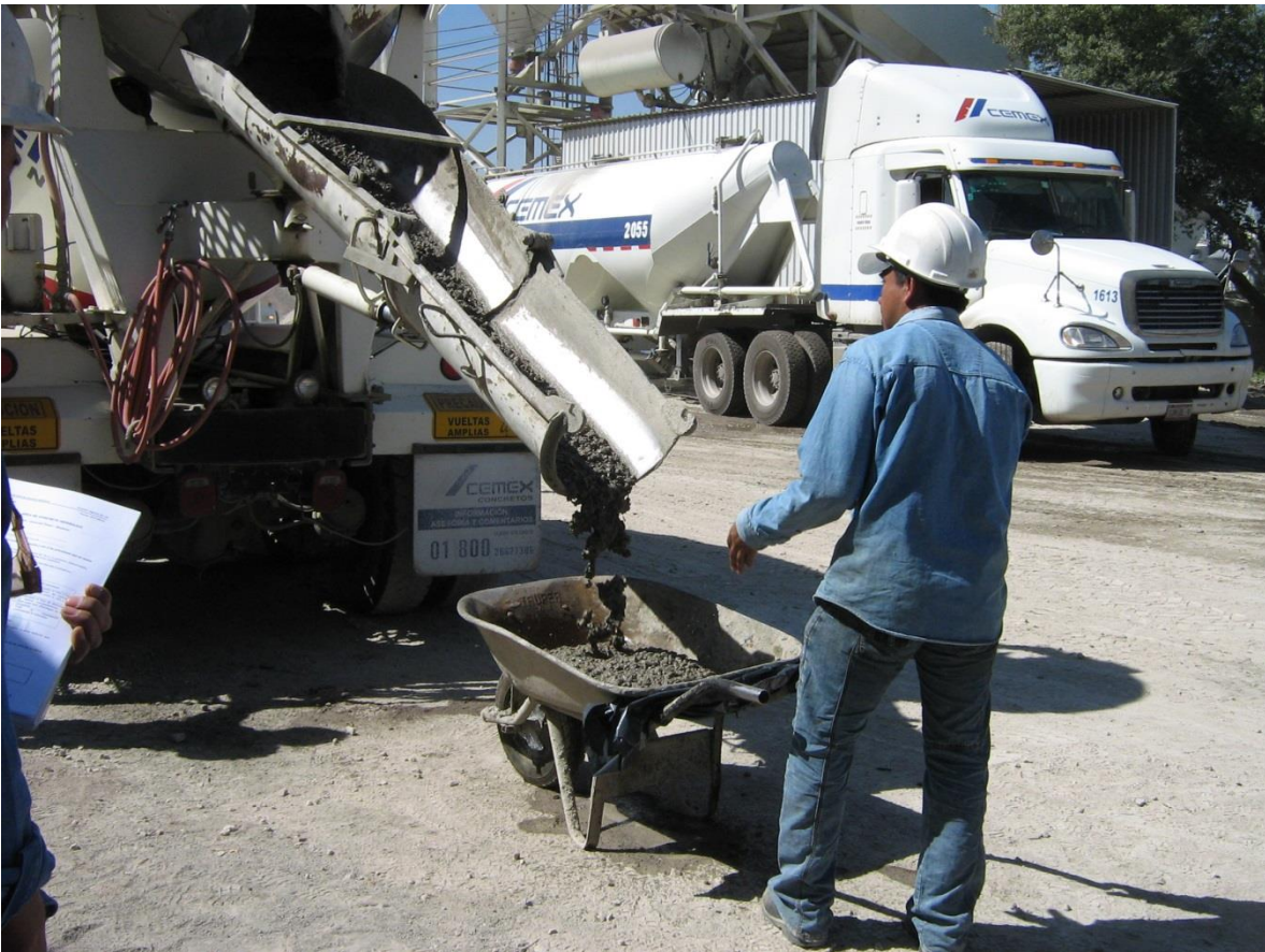
Figura 1.1 Muestreo del concreto fresco.
