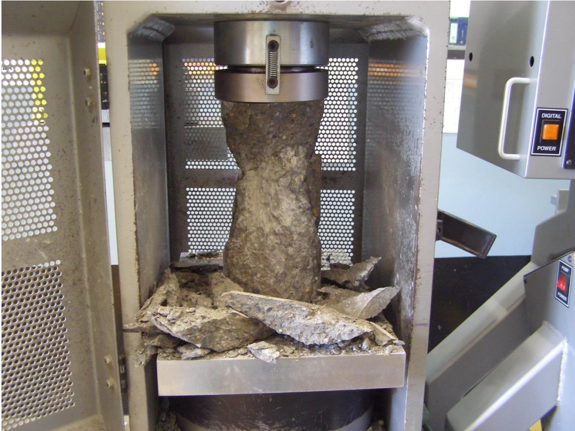
Figura 2.3 Ensayo de especímenes de concreto.
