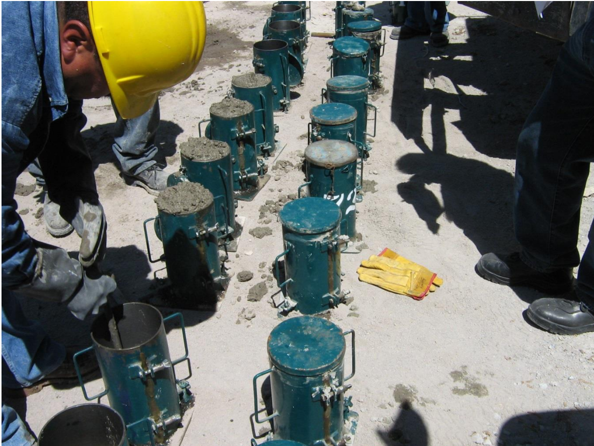
Figura 1.3 Elaboración de especímenes cilíndricos.
