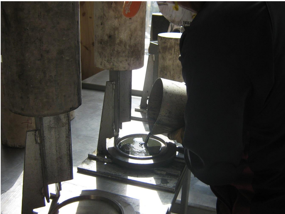
Figura 2.2 Cabeceo de especímenes de concreto.
