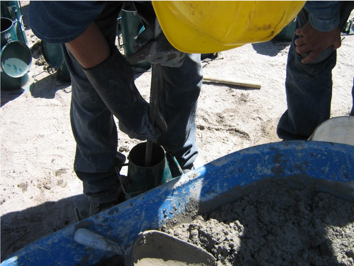
Figura 1.2 Elaboración del revenimiento.
