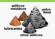
Técnica de conformado de materiales a partir de polvo metálico, cerámico o mezcla.
