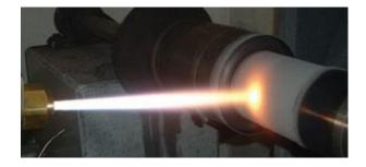
El CermaClad es de entre diez a 100 veces más rápido en la soldadura láser que el sistema de plasma térmico
