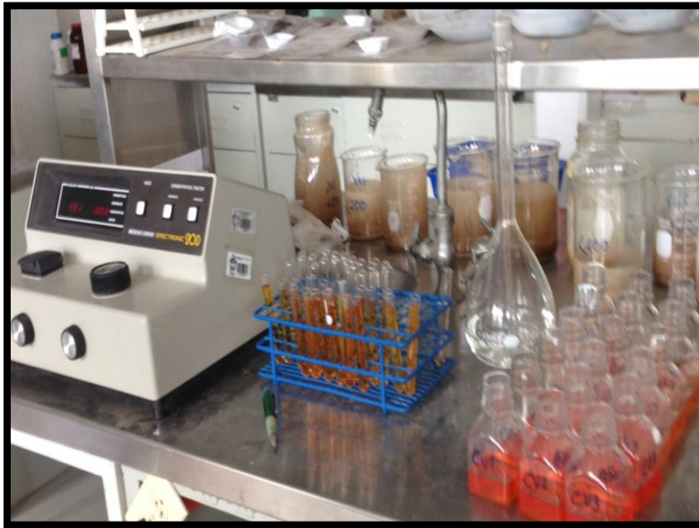
Figura 7. Análisis químico de las compostas (lectura en Espectrofotómetro).
