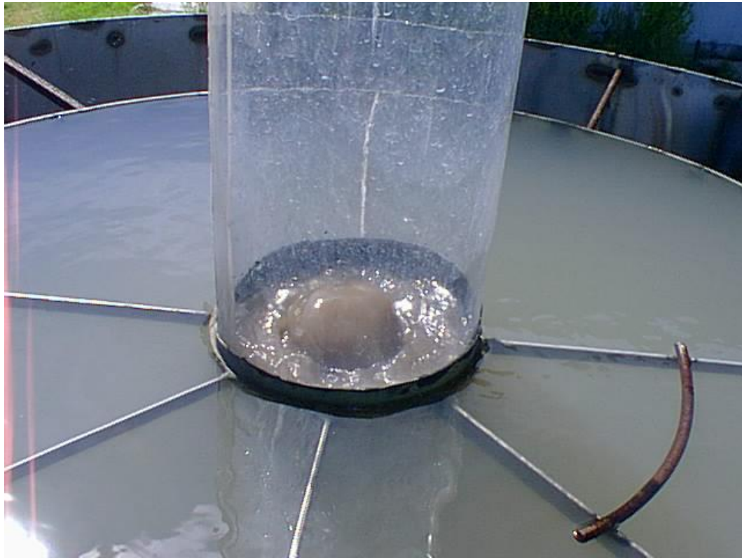
Figura M-2 Unidades cilíndricas de las que consta la planta piloto potabilizadora
