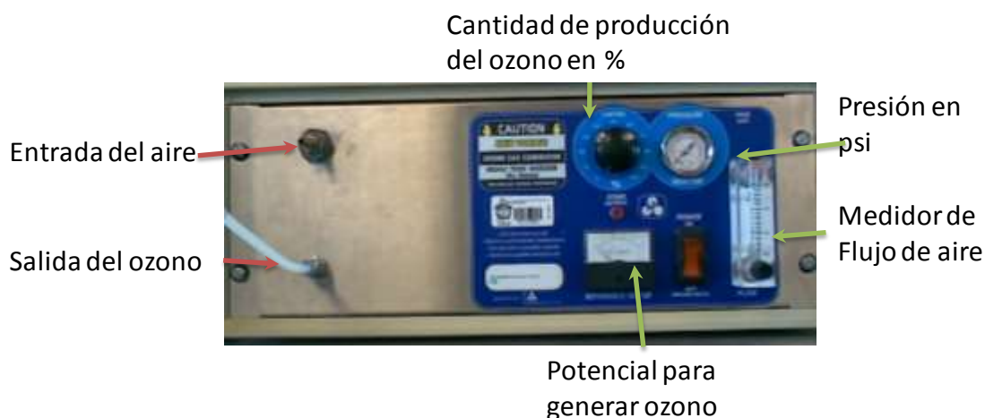
Figura 3.6 Generador de ozono y panel de control [70]
