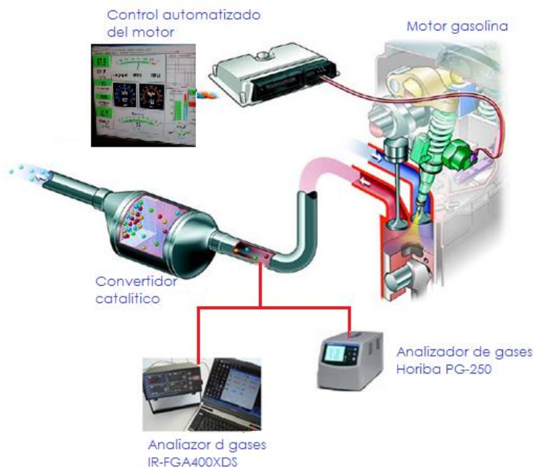
Figura 20 Sistema para caracterización de emisiones de motor de 4 cilindros Chevy-Chevrolet modelo 2002
