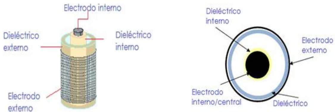
Figura 27 Estructura general de reactor para descarga DBD
