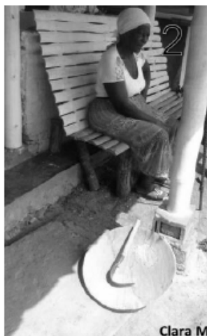
Figura 2. Herramientas utilizadas en la minería ancestral en el sector El Palmar. Registro de los encuentros exploratorios. Foto 1: Batea utilizada para el lavado por separación gravimétrica. Foto 2: Almocafre para remover el material. Foto 3: Jagua, material sobrante compuesto de óxido de hierro, arena negra, oro y/o plata.
