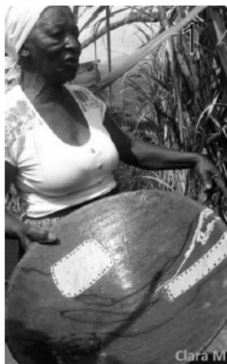
Figura 2. Herramientas utilizadas en la minería ancestral en el sector El Palmar. Registro de los encuentros exploratorios. Foto 1: Batea utilizada para el lavado por separación gravimétrica. Foto 2: Almocafre para remover el material. Foto 3: Jagua, material sobrante compuesto de óxido de hierro, arena negra, oro y/o plata.
