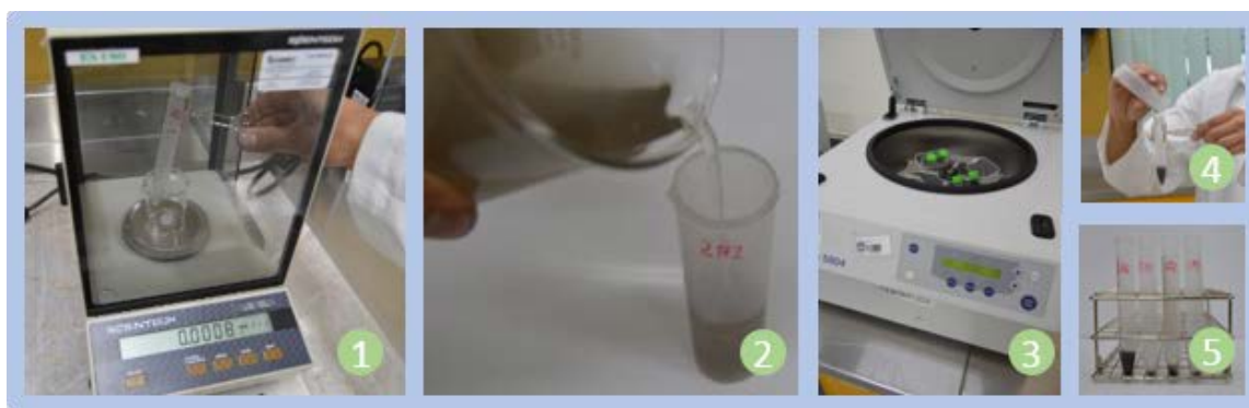
Figura 2.4. Traslado y centrifugado de muestras para la cuantificación de material particulado depositado. Fotografías propias.
