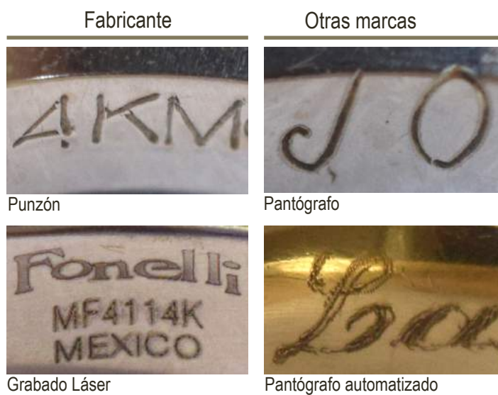
Figura 82. Tecnologías empleadas en las marcas de las argollas matrimoniales. Toluca, México. Fuente: Elaboración propia (2016).
