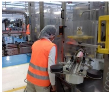
Figura 4.7 Paso 3: inspección visual de equipo detenido
