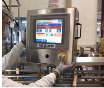
Figura 4.6 Paso 2: paro de etiquetadora desde panel de control
