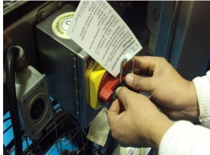
Figura 4.12 Paso 10: remoción de equipos de seguridad
