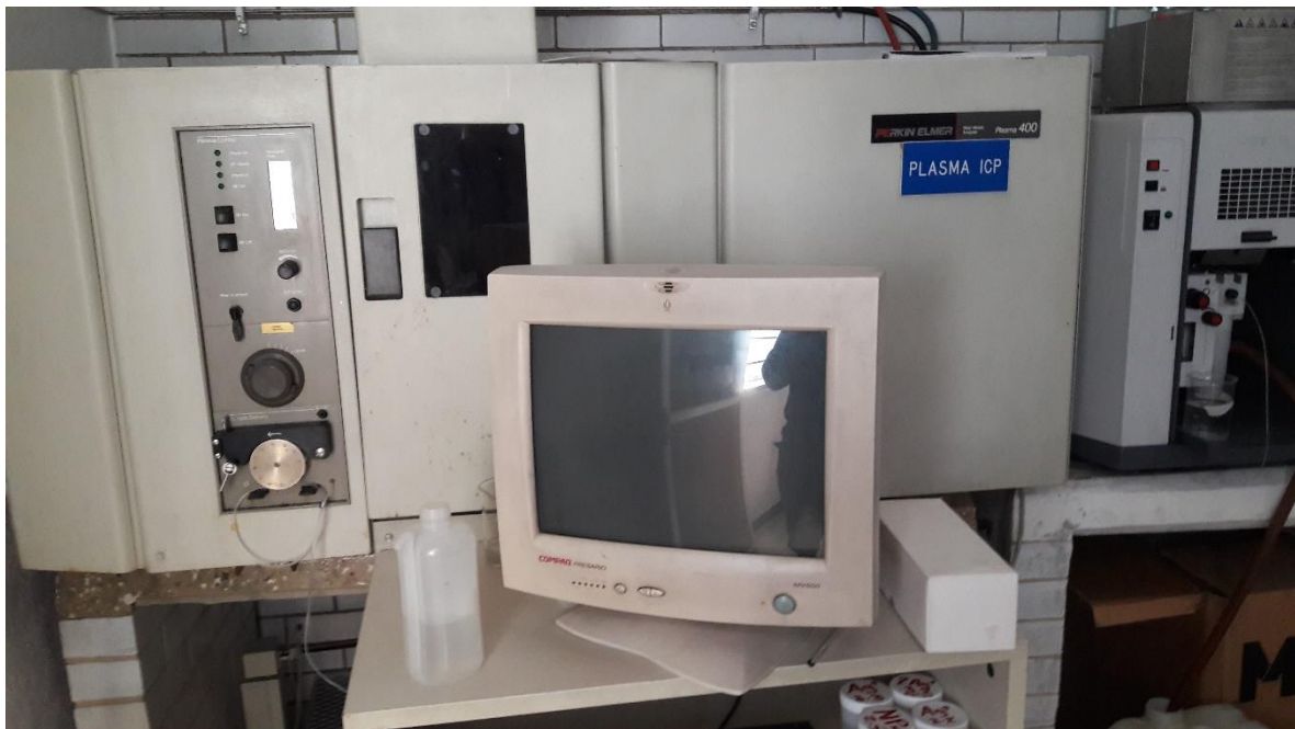
Figura 21: Inducción Acoplada por Plasma (ICP-OES), laboratorio de radiactividad natural del Instituto de Geofísica, UNAM.
