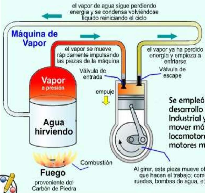
Una máquina de vapor es un motor de combustión que transforma el calor del vapor de agua en movimiento.
