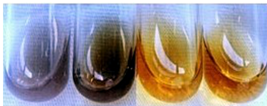
Figura 6 Reacción de hidrolizados con Lugol. P 1 MPa, 30 min, T de izq a der: 120 °C, 140 °C, 160 °C y 180 °C
